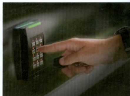
Una delle tecniche di riconoscimento automatico delle persone è basata sulla verifica di un PIN individuale digitato su una tastiera (Doc. HID Global).
