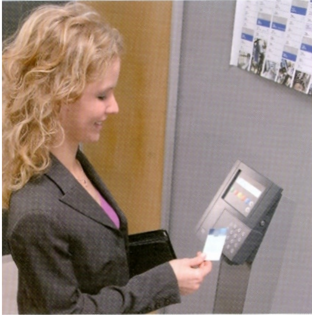
Anche in Italia il transponder RFID sta prendendo il posto del badge magnetico (ancora largamente diffuso), mentre all'orizzonte si affacciano i primi sistemi di identificazione biometrica. In particolare l'impronta digitale e la geometria della mano (Ider, Kaba).
